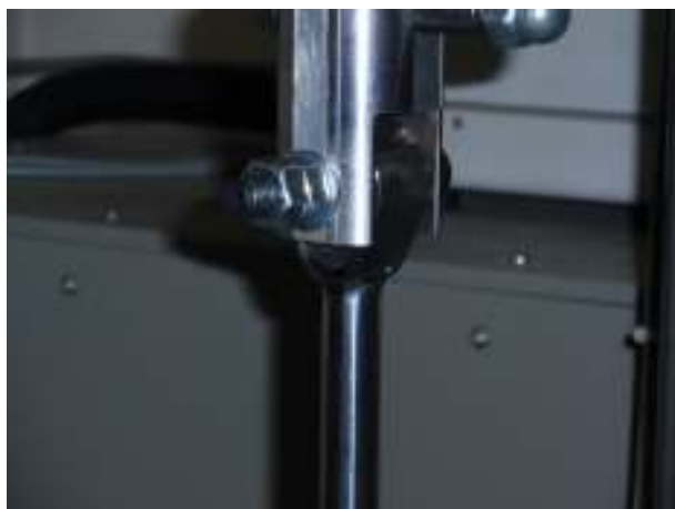
Slika 2: Zglobno pričvršćenje spone za ispitni uređaj
