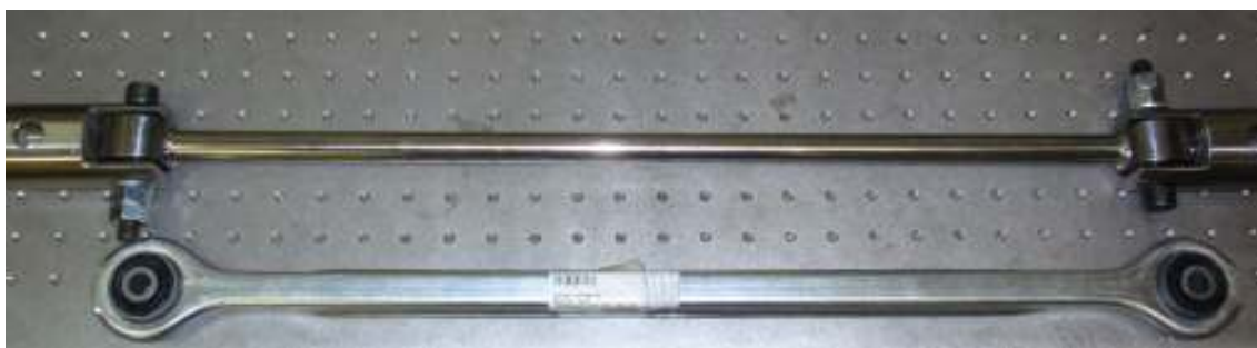
Slika 1: Originalna (donja) i nova konstrukcija (gornja) AR spona
