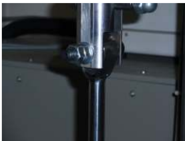
Slika 2: Zglobno pričvršćenje spone za ispitni uređaj
